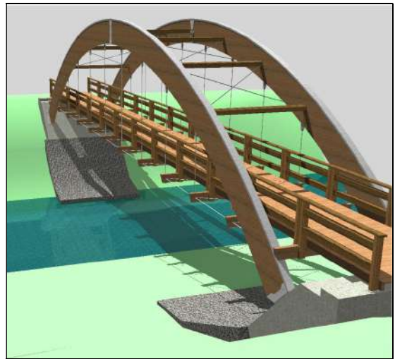
Viste tridimensionali della passerella in legno lamellare in progetto – Giavenale (VI)
